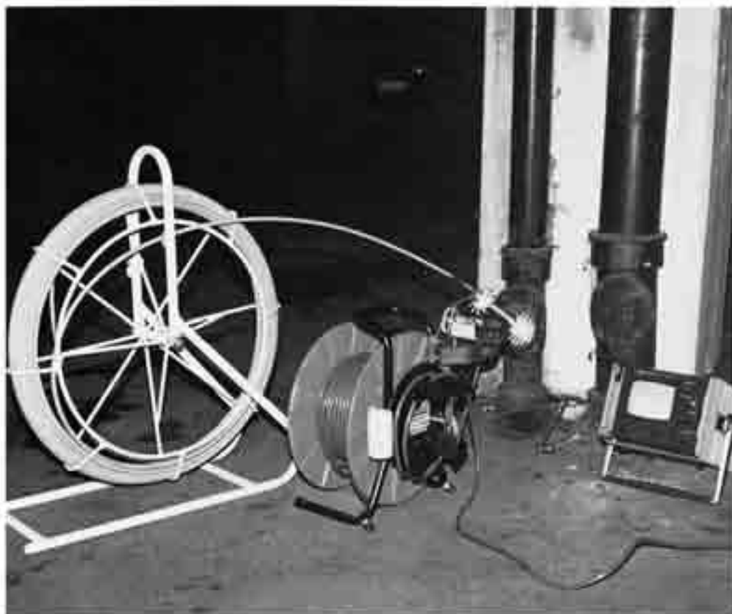
CCD-kamera och inspelningsutrustning med rörål samt signalkabel.
