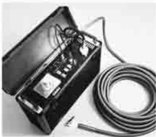
Fiberoptisk utrustning för klena rördimensioner.
